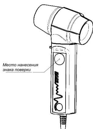
г) Схема пломбировки и маркировки спирометра MAC2-ПКМ
