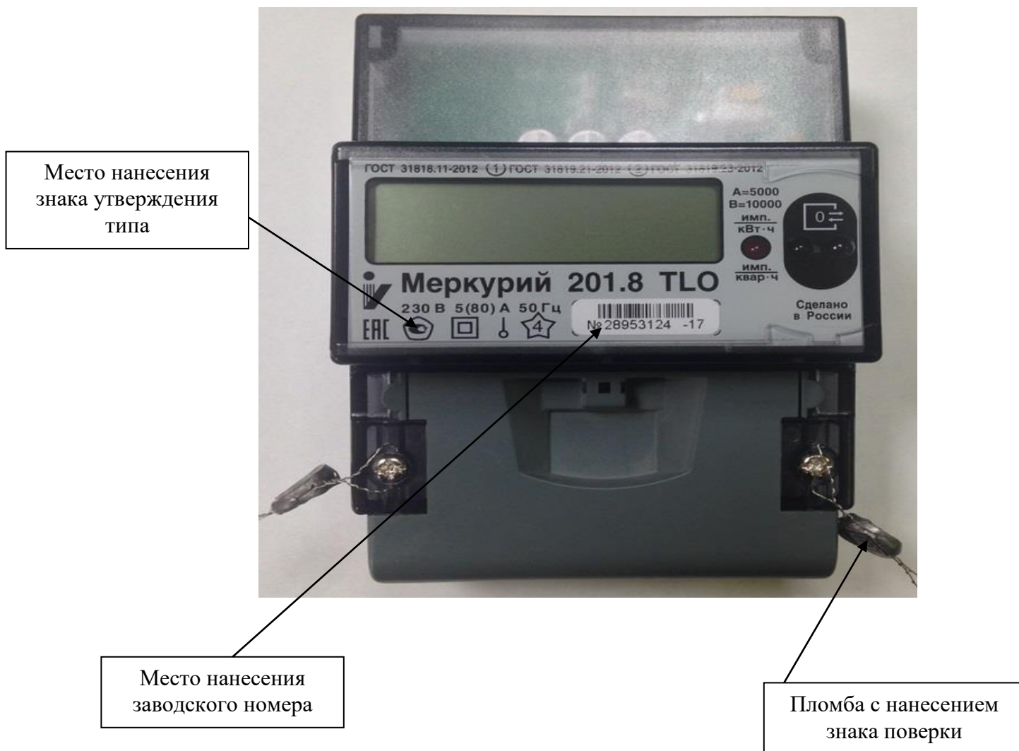
Рисунок 1 – Общий вид счетчиков с указанием места ограничения доступа к местам настройки (регулировки), места нанесения знака утверждения типа, места нанесения заводского номера
