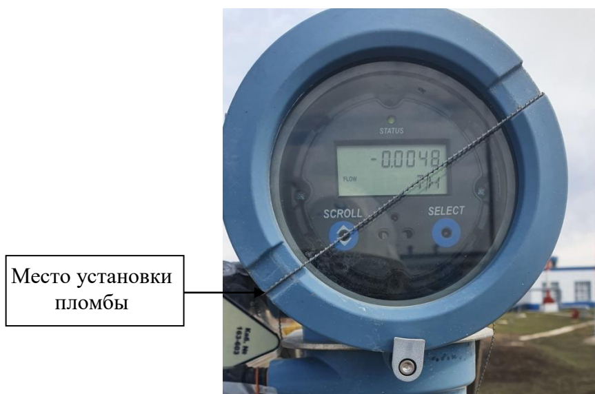
Рисунок 2 – Место установки пломбы для защиты от несанкционированных настройки и вмешательства преобразователя серии 2700
