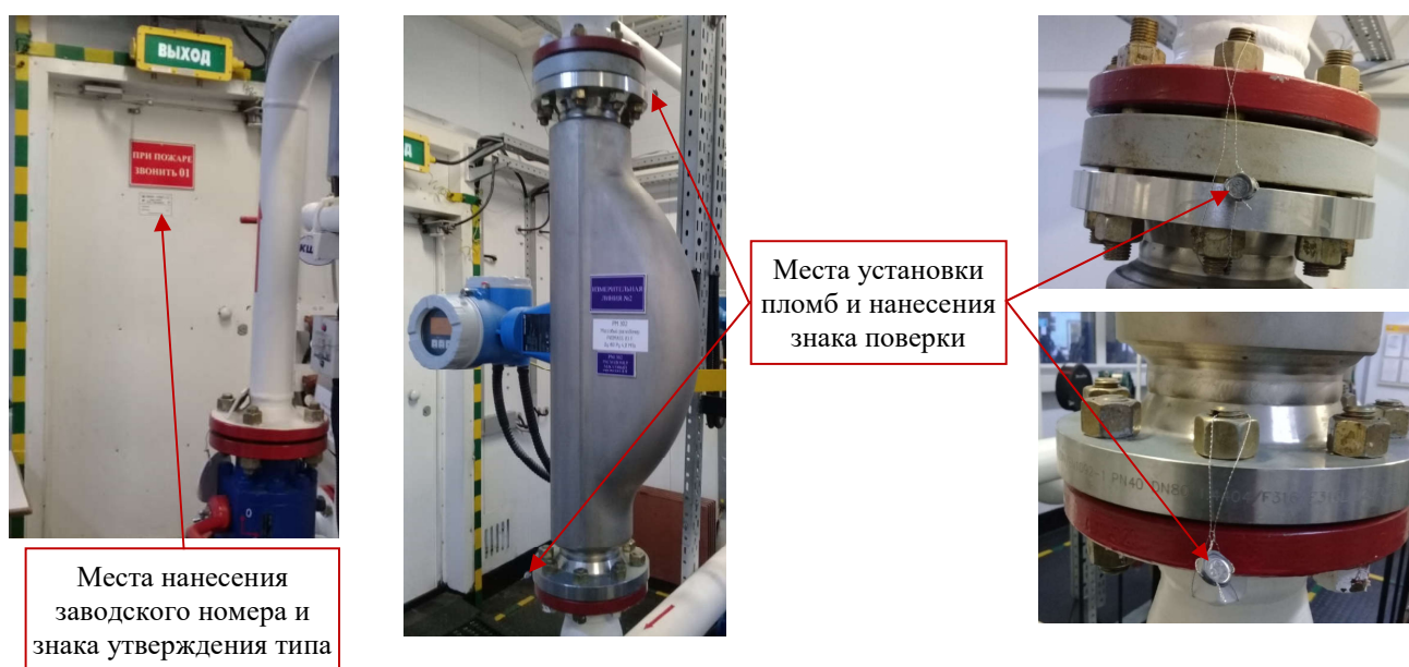
Рисунок 2 – Места нанесения заводского номера, знака утверждения типа, знака поверки и места установки пломб
