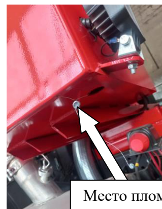
Рисунок 4 – Отсек узла выдачи топлива
