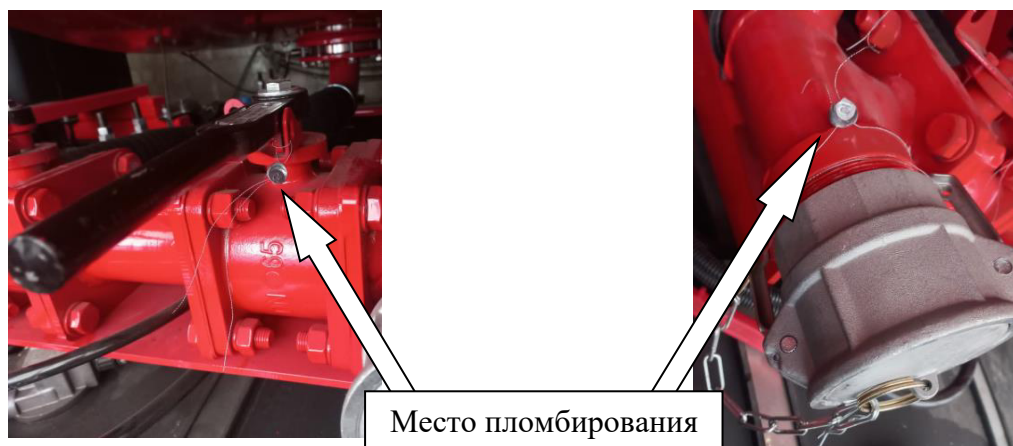
Рисунок 5 – Заглушка быстроразъёмного соединения, кран шаровый на трубопроводе
