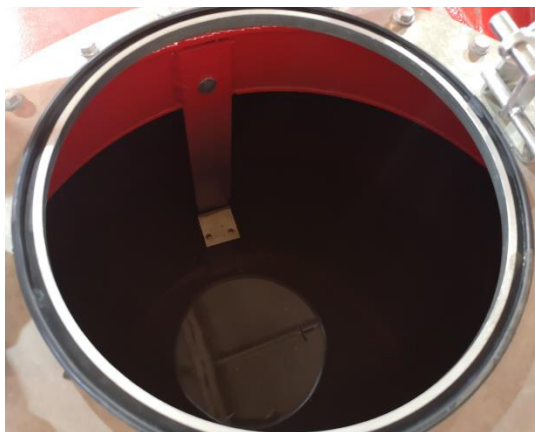
Рисунок 8 – Способ монтажа указателя уровня налива
