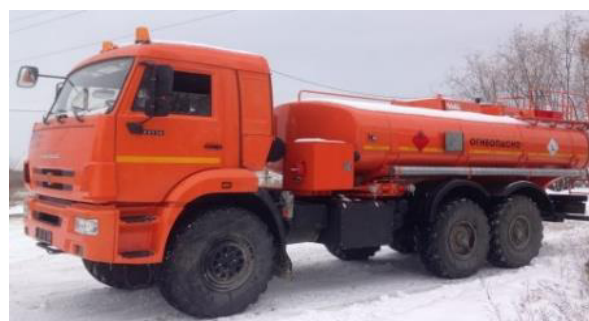
Рисунок 2 – Общий вид АТЗ с двумя секциями
