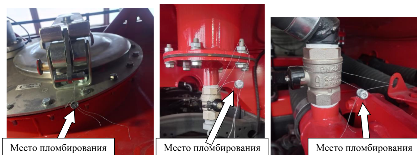
Рисунок 6 – Запорный механизм крышки заливной горловины, кран сливной для слива из отстойника и кран подвода топлива в отсек узла выдачи топлива
