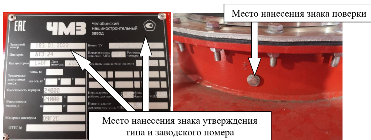
Рисунок 7 – Маркировочная табличка, указатель уровня налива (мерный угольник)
