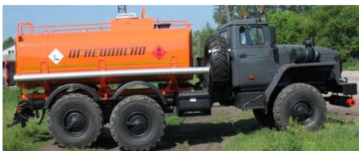
Рисунок 1 – Общий вид АТЗ с одной секцией
