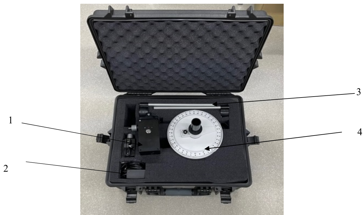
1 - раскручивающее устройство КПП-4М-1, 2 - раскручивающее устройство КПП-4М-2, 3 - кронштейны и крепежные приспособления, 4 - лимб со стрелкой Рисунок 2 – Общий вид комплексов поверочных портативных КПП-4, модификация КПП-4М
