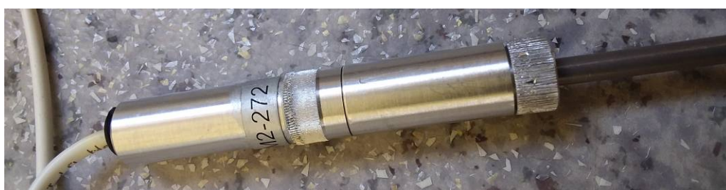
Рисунок 2 – Место нанесения заводского номера
