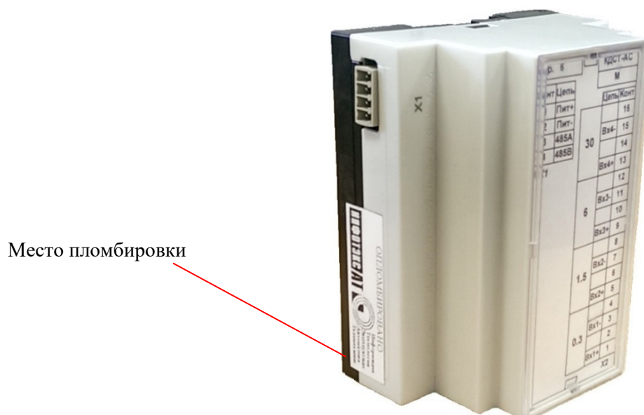
Рисунок 1 - Общий вид контроллеров диагностики сигнальной точки измерительных КДСТ-АС и схема пломбировки от несанкционированного доступа
