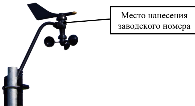
Рисунок 3 – Общий вид датчика SENSE-WIND для измерения скорости воздушного потока и направления воздушного потока (анемометра)
