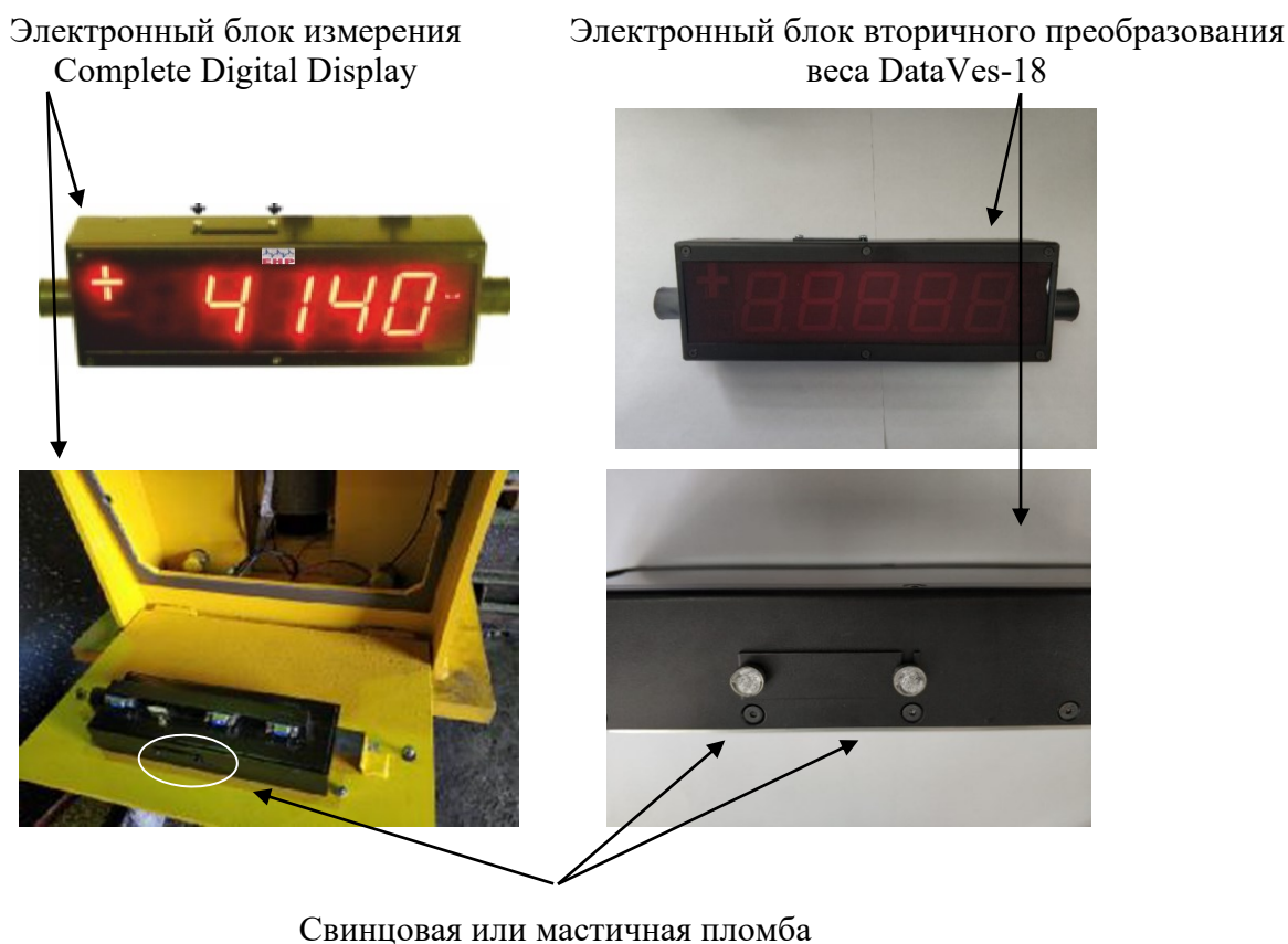
Рисунок 2 - Схема пломбировки от несанкционированного доступа электронного блока измерения Complete Digital Display и электронного блока вторичного преобразования веса DataVes-18.
