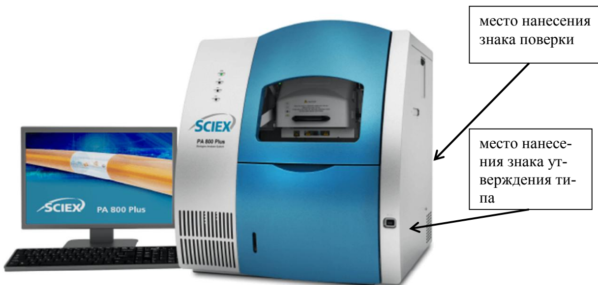
Рисунок 1 - Общий вид системы капиллярного электрофореза PA800 Plus и обозначение места нанесения знака утверждения типа
