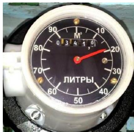
Рисунок 2 – Экран измерительного узла счетчиков
