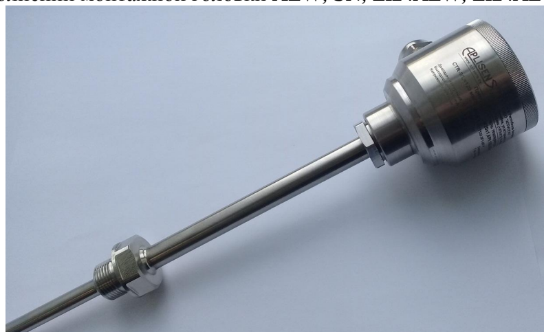
Рисунок 5 – Общий вид термопреобразователей СТУ исполнения монтажной головки PZ
