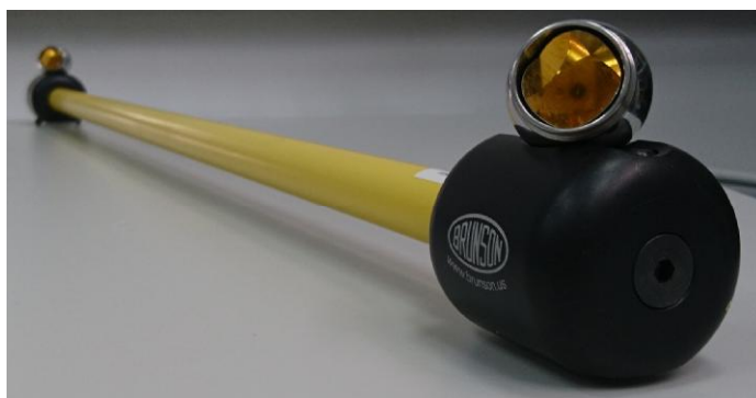
Рисунок 2 - Внешний вид меры с двумя установленными отражателями
