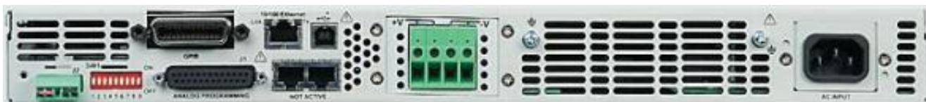
Рисунок 5 – Общий вид источников питания постоянного тока серии N5700. Вид задней панели источников с выходным напряжением 600 В и мощностью до 780 Вт
