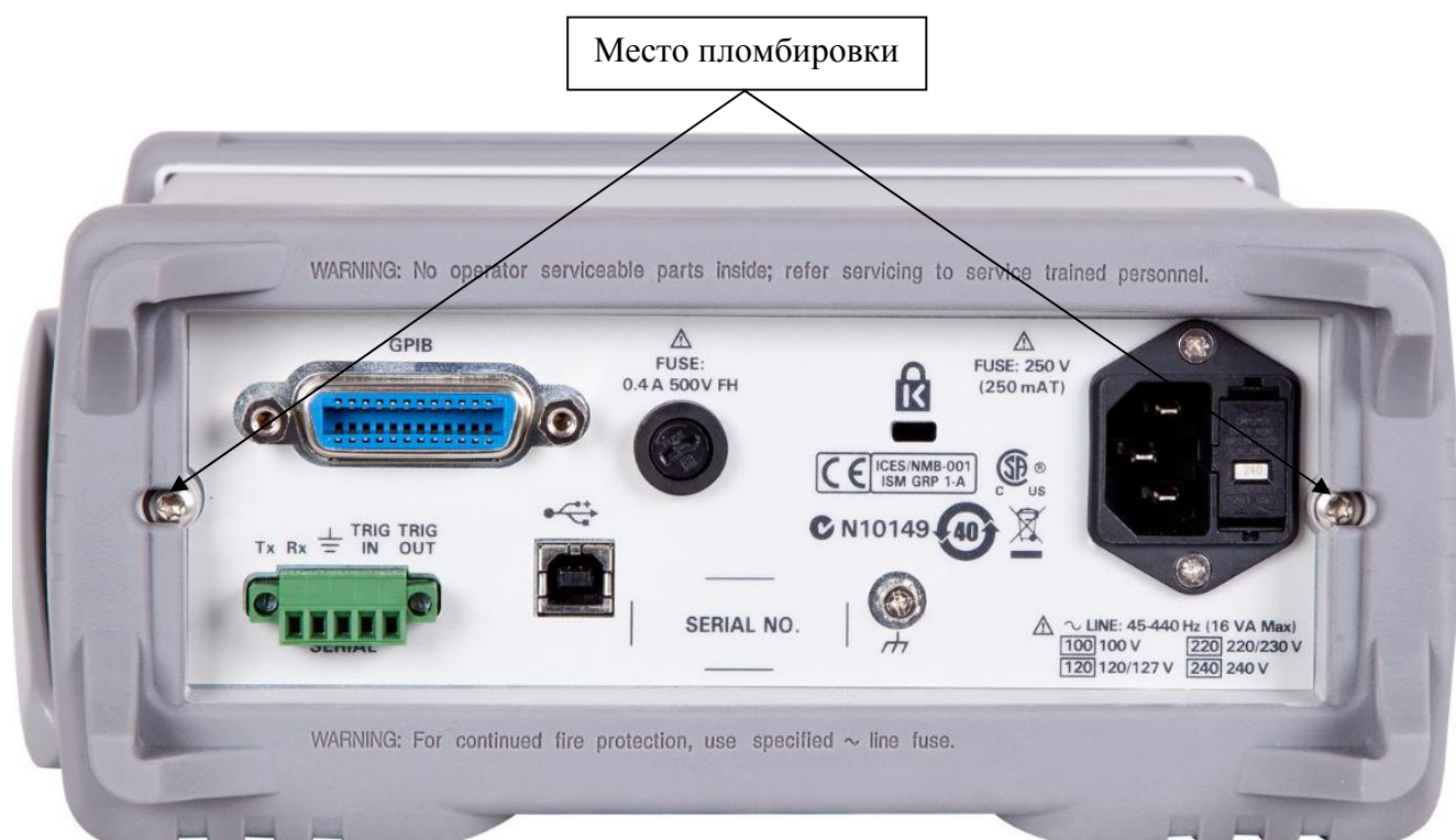
Рисунок 2 – Схема пломбировки от несанкционированного доступа
