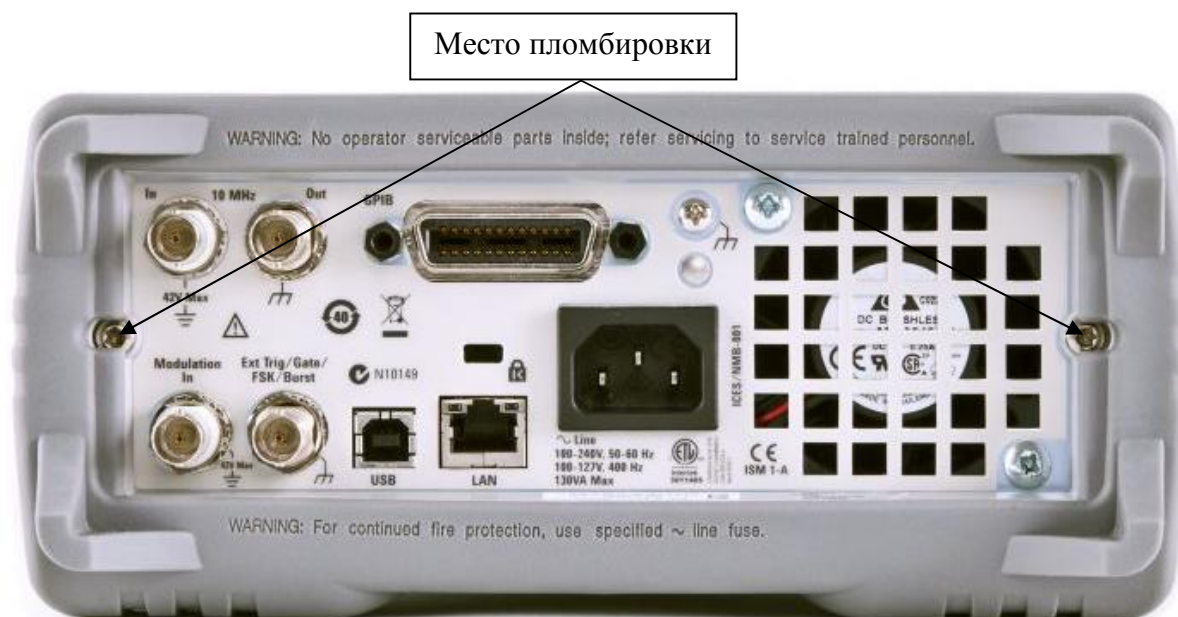
Рисунок 2 – Схема пломбировки от несанкционированного доступа
