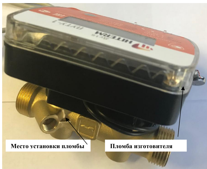
Рисунок 2 - Места пломбирования теплосчетчика ПУТУ-1
