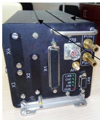
Рисунок 2 - Места нанесения знака утверждения типа и пломбировки от несанкционированного доступа
