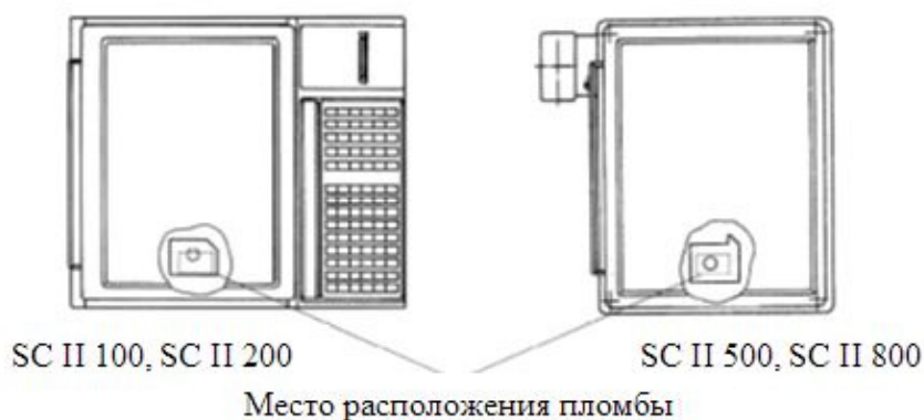
Рисунок 4 — Схема пломбировки исполнений SC II 100, SC II 200, SC II 500, SC II 800
