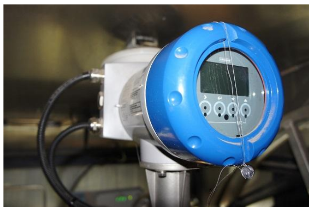
Рисунок 9 – Пломбирование расходомера-счетчика массового
