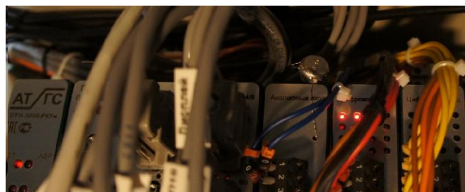
Рисунок 8 – Пломбирование платы аналогового входа контроллера
