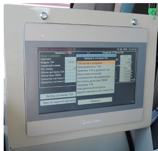
Рисунок 5 – Панель оператора сенсорная (ПОС-10)
