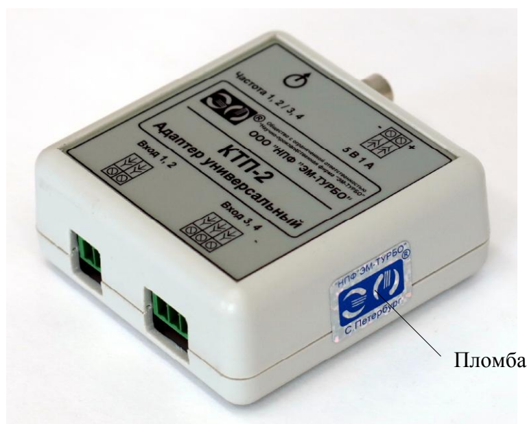
Рисунок 4 – Схема пломбировки АУ от несанкционированного доступа
