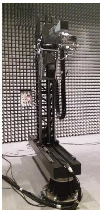
Рисунок 2 – Общий вид опорно-поворотного устройства PS-AZ-SL-EL-PL-60 (слева) и однокоординатного поворотного устройства PS-AZ-10 (справа)
