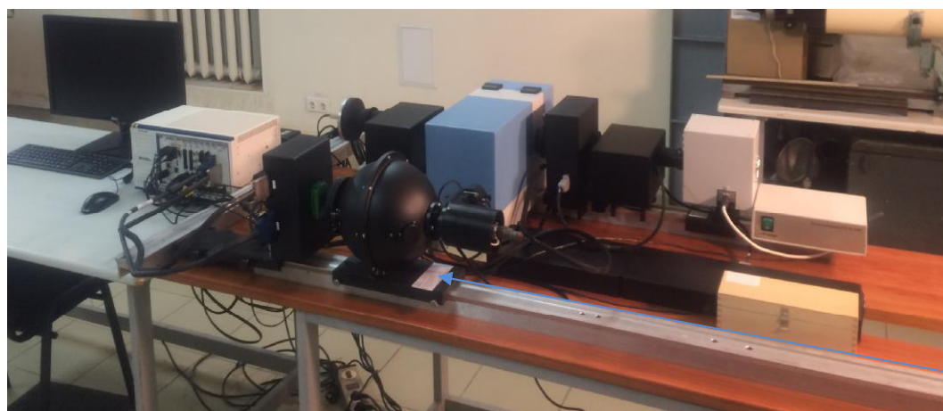
Рисунок 1 – Общий вид измерительного стенда для измерения параметров матрицы с межстрочным переносом с размером фоточувствительного элемента 7,4 \text{ мкм} \times 7,4 \text{ мкм} «Фонон-3-Омега» ФРАЕ.468993.095
