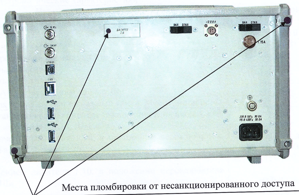
Рисунок 2 – Места пломбировки от несанкционированного доступа
