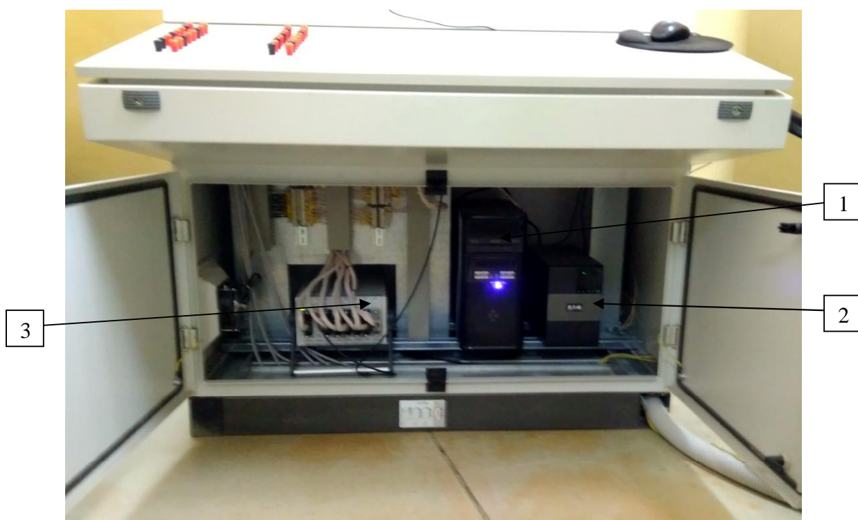
1 – ПК Intel Pentium G3420; 2 – источник бесперебойного питания EATON Evolution 650; 3 – установка измерительная LTR-EU-8-1
