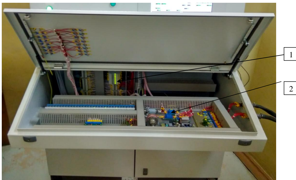
1 – модули электронные WAD-A-MAX; 2 – датчики тока LA25-NP/SP44 с резисторами прецизионными SMD1206
