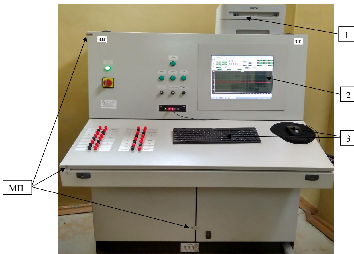
1 – лазерное печатающее устройство Brother HL-2132; 2 – сенсорный резистивный монитор EASY MOUNT 17 TG1701W4EM; 3 – клавиатура с манипулятором типа «мышь» Genius Slim Star 18150
