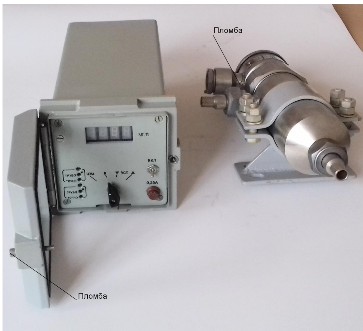
Рисунок 1 - Общий вид солемера показывающего сигнализирующего типа «САМ01»
