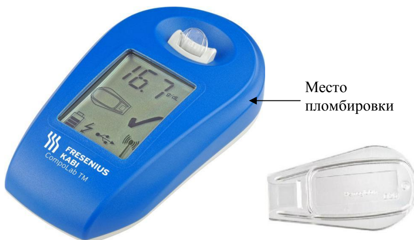
Рисунок 1 - Общий вид анализатора портативного ComproLab TM для определения гемоглобина в крови
