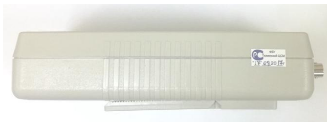
Рисунок 2 – Схема пломбировки от несанкционированного доступа
