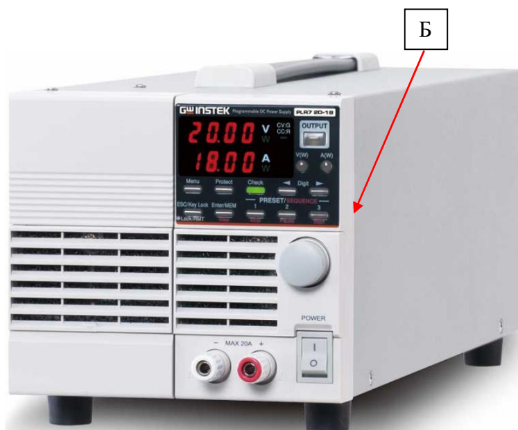
Рисунок 2 – Схема пломбировки от несанкционированного доступа (Б)
