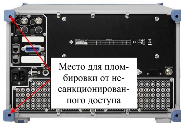
Рисунок 7 – Общий вид ВАЦ ZVA 24 и задняя панель с указанием мест для пломбировки от несанкционированного доступа
