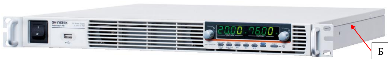
Рисунок 2 – Схема пломбировки от несанкционированного доступа (Б)
