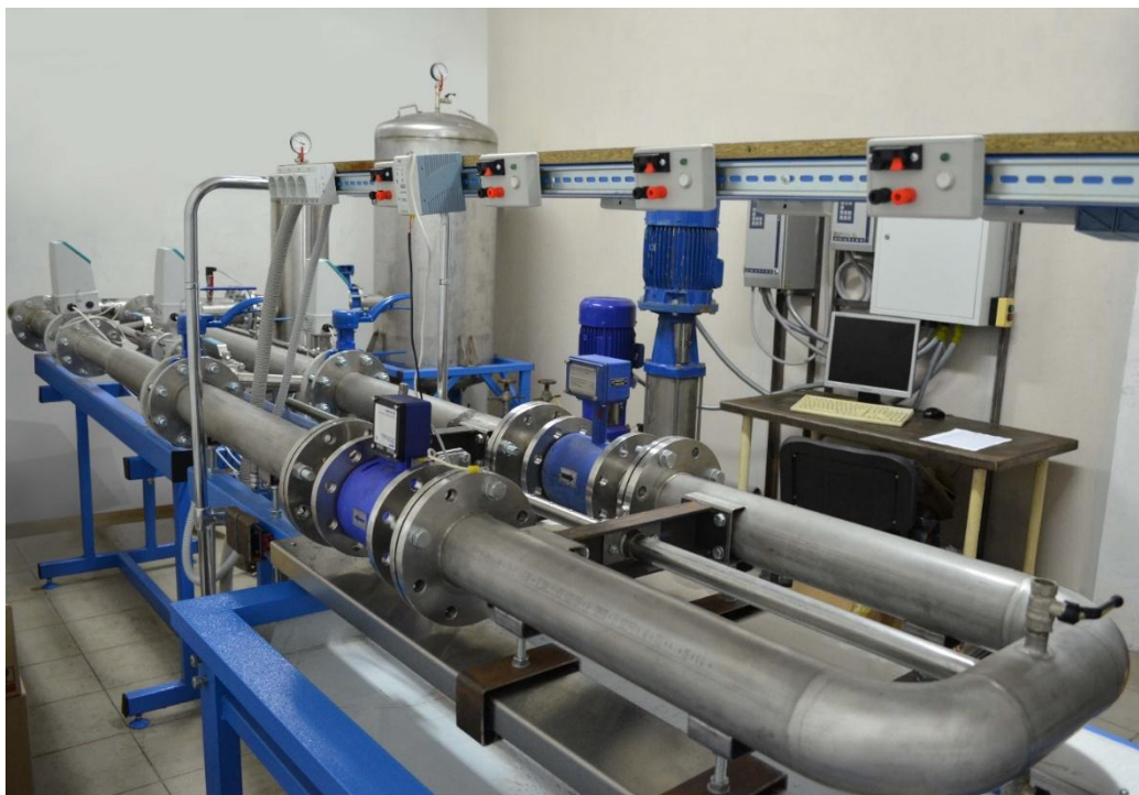
Рисунок 1 – Общий вид установки поверочной FLOWTEST-7
