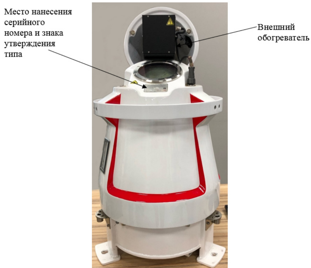
Рисунок 4 – Общий вид приборов SKYDEX-15 с указанием мест нанесения серийного номера и знака утверждения типа
