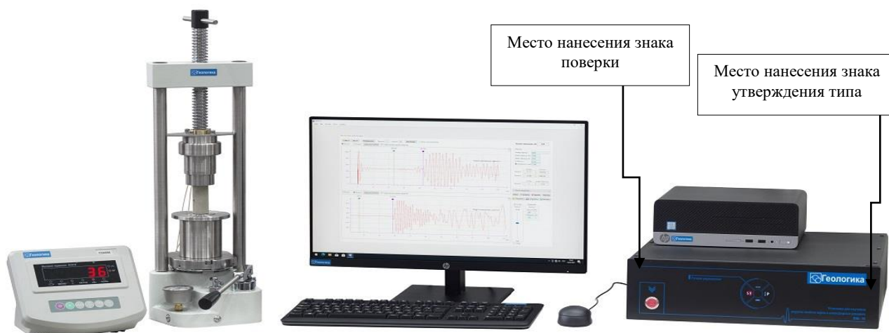
Рисунок 2 – Общий вид, место нанесения знака поверки и знака утверждения типа для установки для изучения упругих свойств керна в атмосферных условиях ПИК-УЗ с встроенным осциллографом в блок управления и устройством для фиксации образцов (пресса) с блоком индикации усилия
