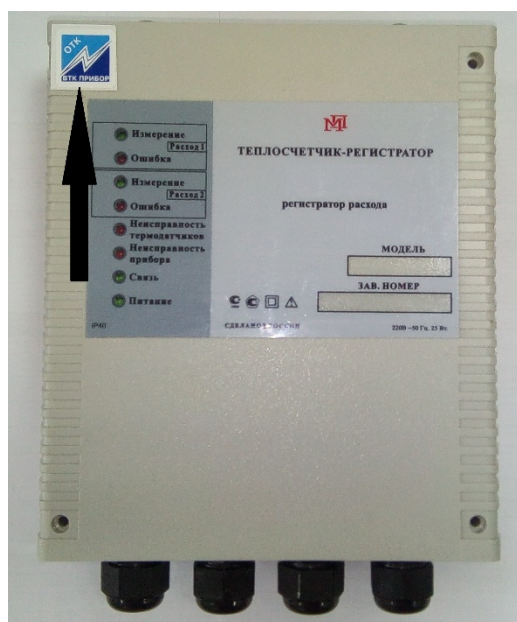
Рисунок 7 – Схема пломбировки от несанкционированного доступа, обозначение места нанесения знака поверки на корпус регистратора расхода отдельно-выносного исполнения
