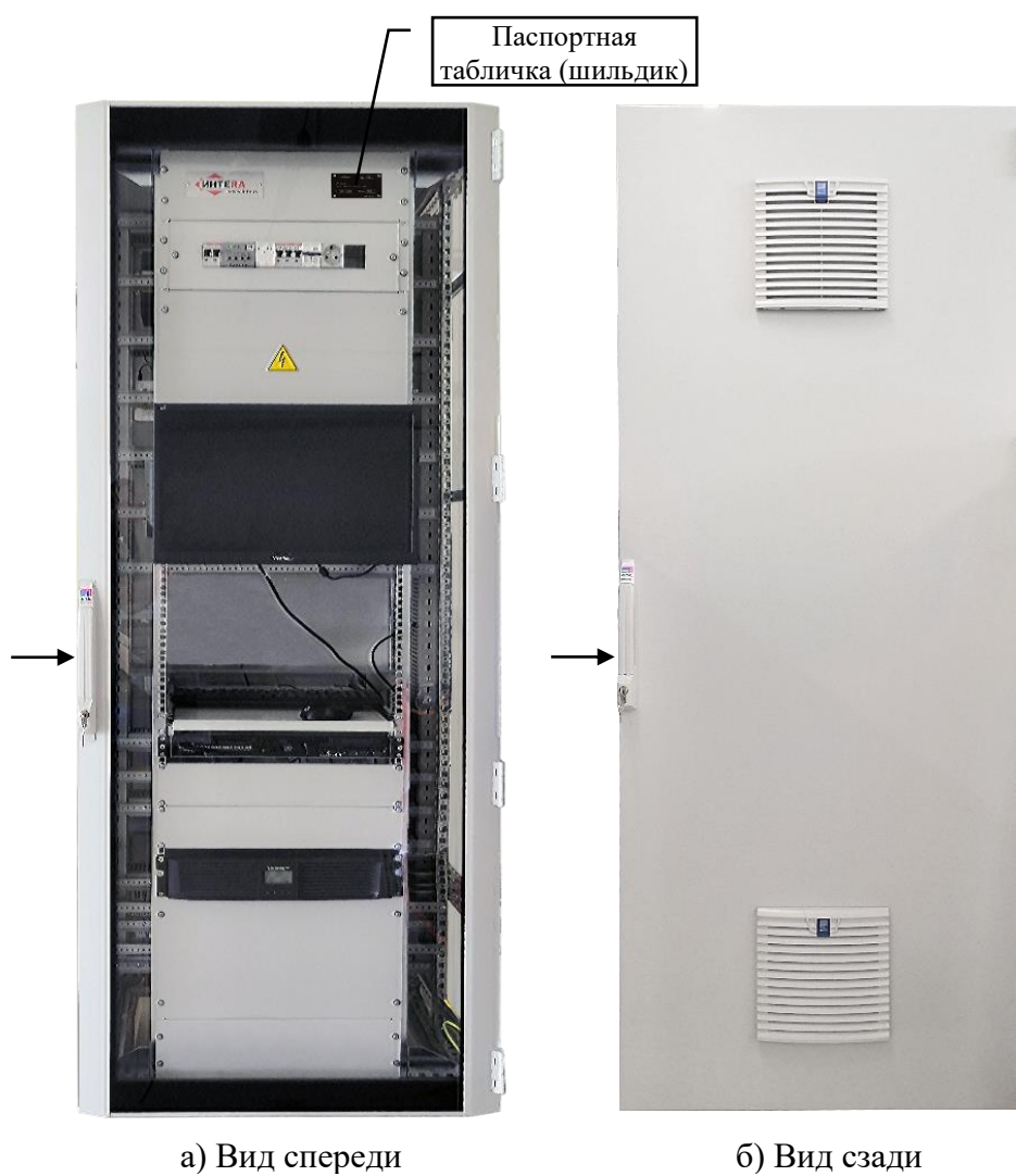
Рисунок 2 - Общий вид ШК СМ «СКУ», стрелками показаны механические замки шкафа
