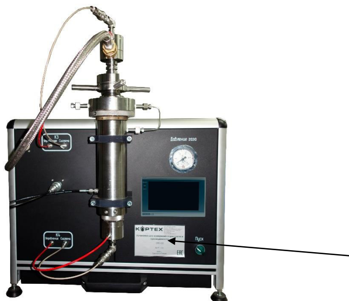
Рисунок 4 – Общий вид установки для измерения пористости и проницаемости СМП-ПП с манометром входного давления и цифровой информационной панелью с указанием места нанесения маркировки
