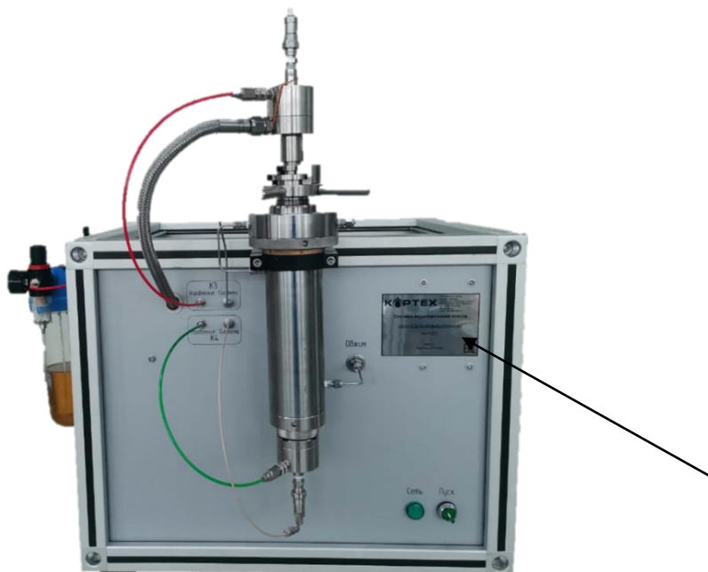
Рисунок 1 – Общий вид установки для измерения пористости и проницаемости СМП-ПП без манометра входного давления с указанием места нанесения маркировки
