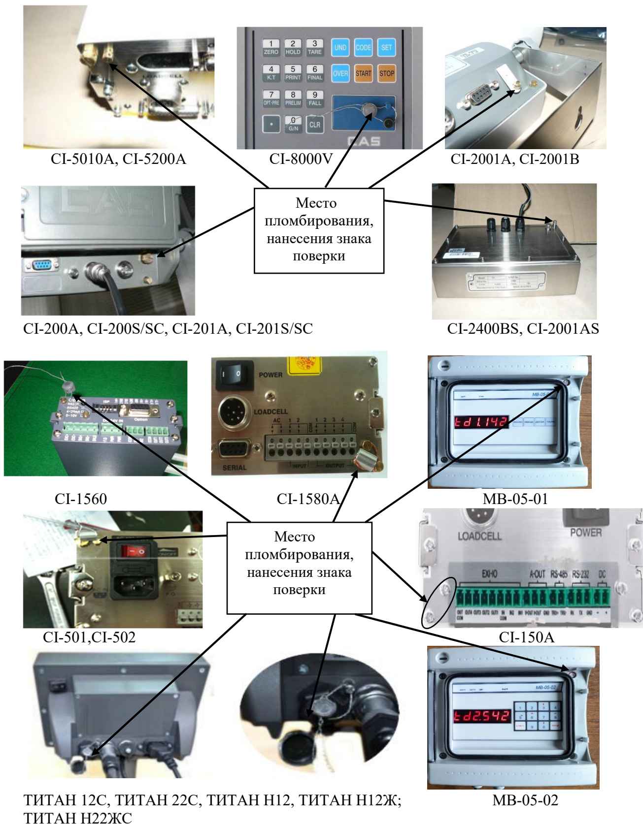
Рисунок 3 – Схема пломбировки от несанкционированного доступа, место нанесения знака поверки для весов
