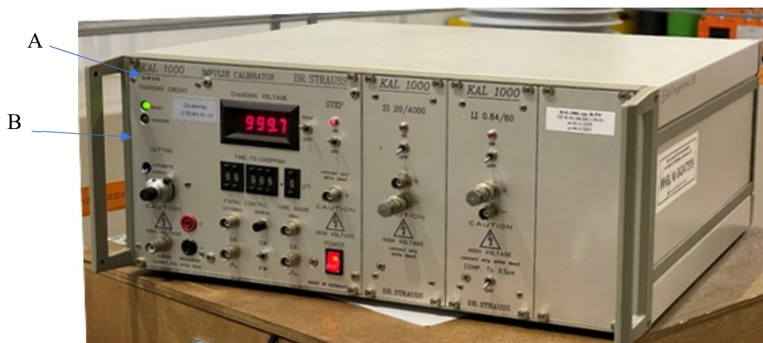
Рисунок 1 – Общий вид калибратора импульсов KAL 1000
