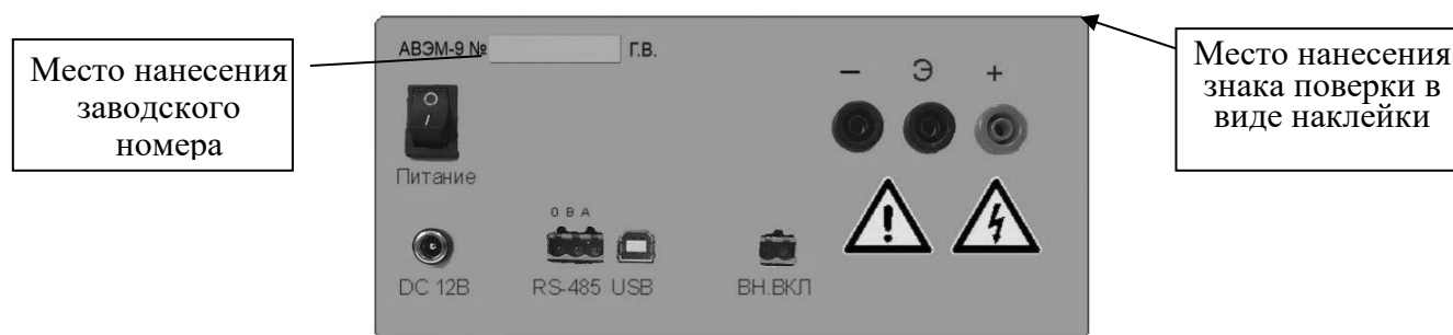
Рисунок 2 – Схема пломбировки мегаомметров от несанкционированного доступа, обозначение места нанесения заводского номера
