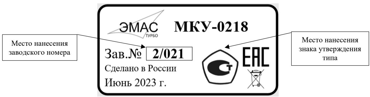
Рисунок 2 – Место нанесения заводского номера
