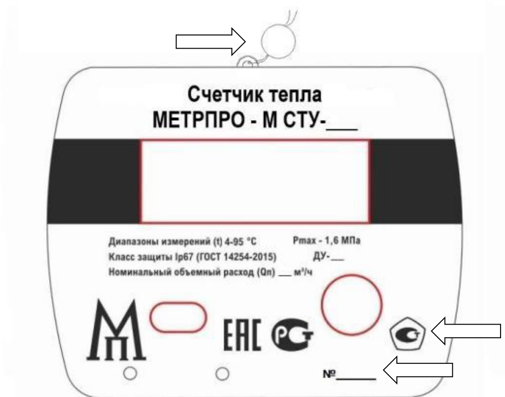
Рисунок 2 – Схема пломбировки от несанкционированного доступа, обозначение мест нанесения знака поверки, знака утверждения типа и заводского номера
