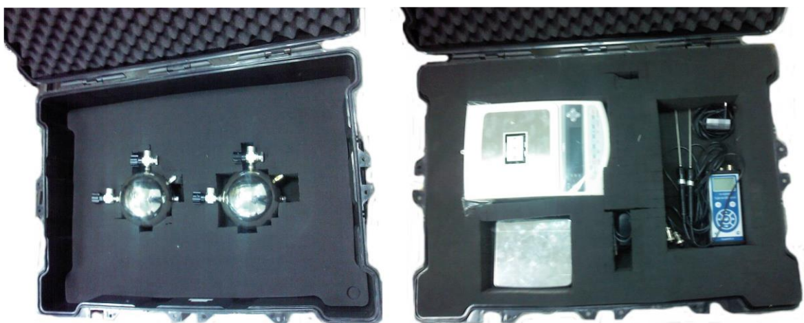
Рисунок 1 – Общий вид установки пикнометрической ПУ-ИнКС
