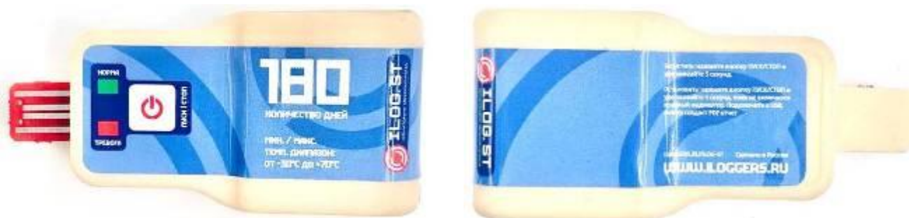
Рисунок 1 – Общий вид измерителей-регистраторов температуры однократного применения iLog.St модели iLog.St
