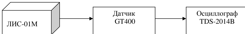
Рисунок 1 - Структурная схема поверки датчиков GT400 с использованием ЛИС-01М
