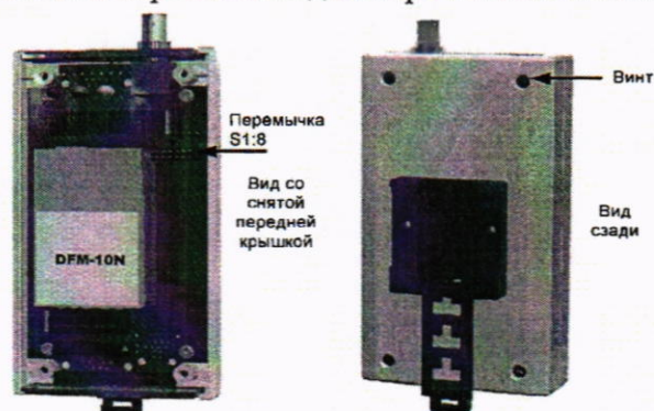
Рисунок 2 - Схема пломбирования контроллера DataBox RP-K-02-CR
