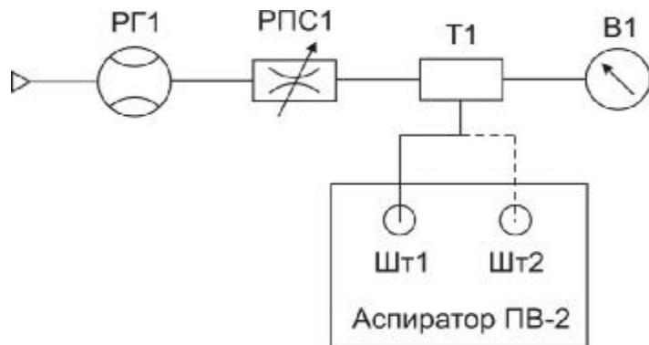
РГ1 – расходомер газа; РПС1 – регулируемое пневмосопротивление; Т1 – тройник;
