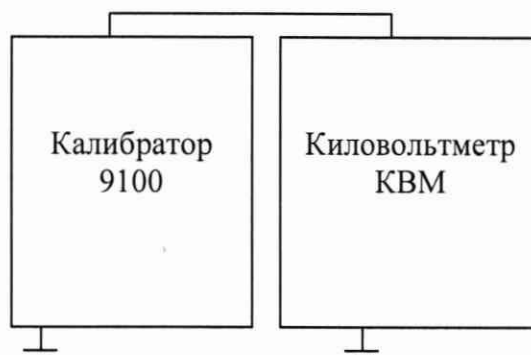
Рисунок 3 – Схема измерений в диапазоне частот от 50 до 400 Гц
