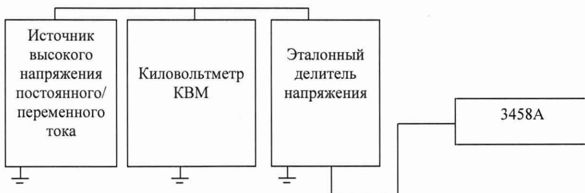
Рисунок 2 – Схема измерений на напряжении свыше 1 кВ
