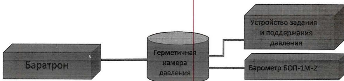
Схема № 2. Схема подключения датчика давления мембранно-емкостного Баратрон 698А к комплексам КПП-1
